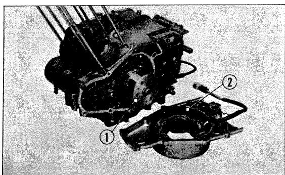
① A.C. generator rotor ② A.C. generator stator
