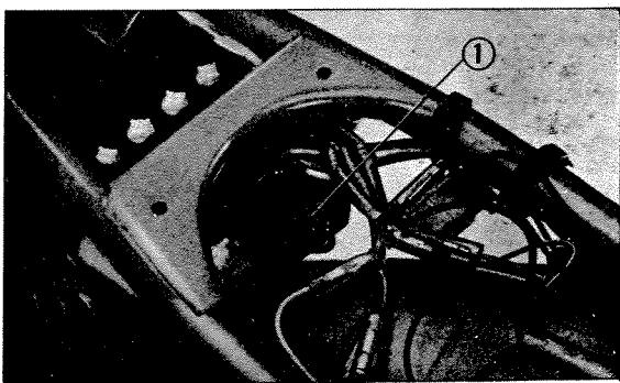
Fig. 5-14. Selenium rectifier
