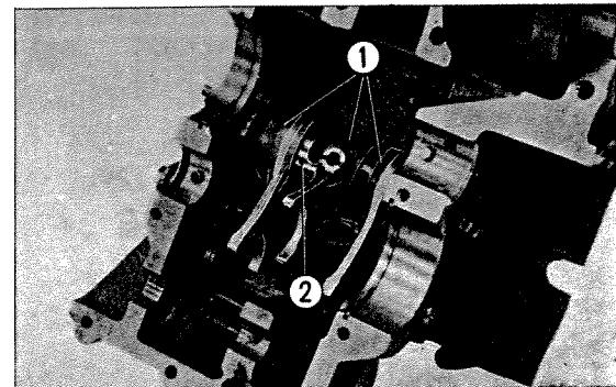
① Gear shift fork ② Gear shift drum
