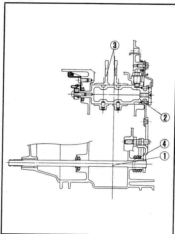
① Gear shift spindle ② Gear shift drum
