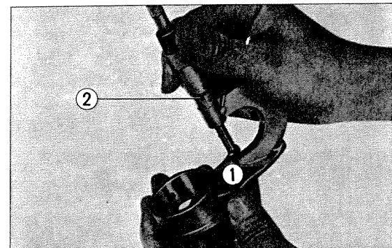
① Gear shift fork ② Micrometer
