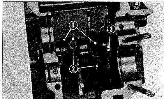
① Gear shift fork ② Guide pin clip ③ Gear shift drum
