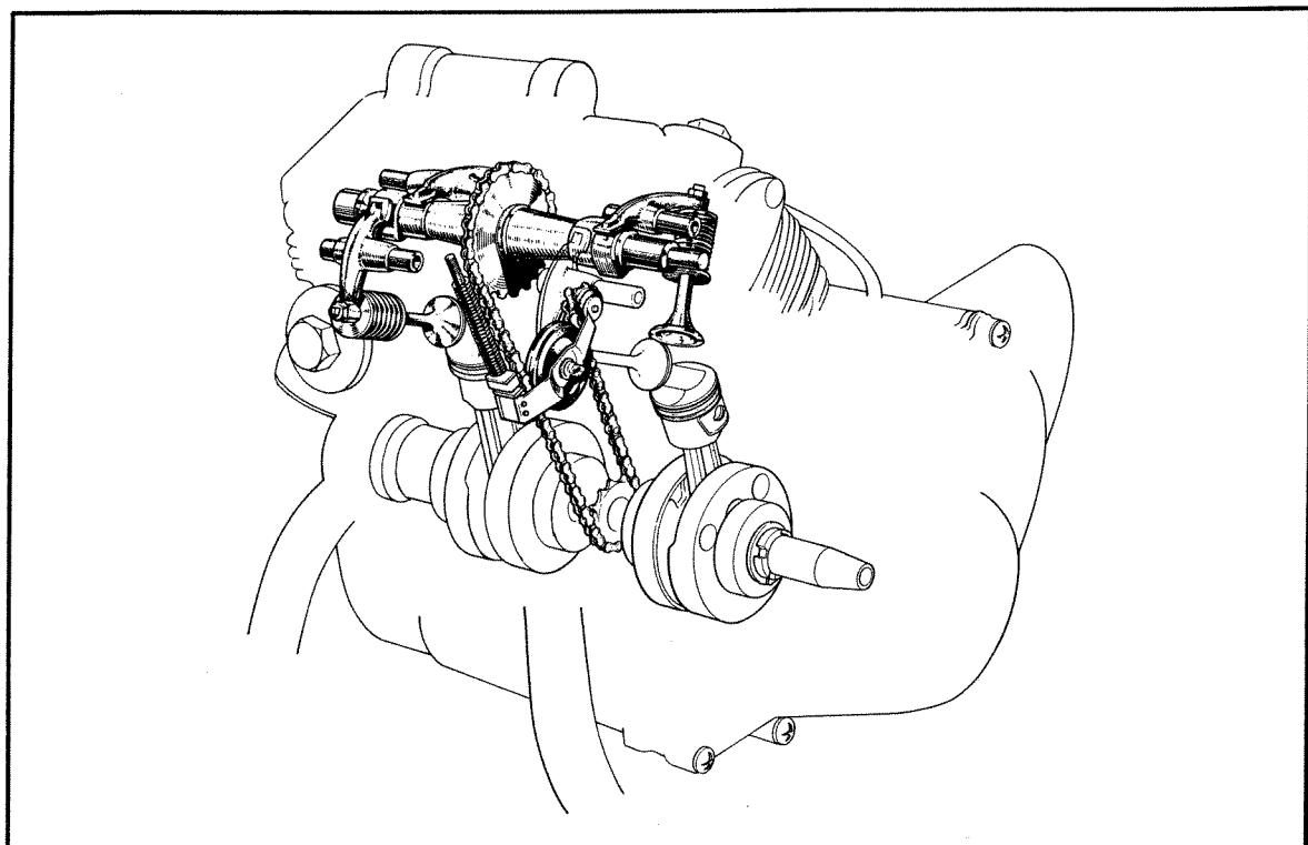
Fig. 3-9. Valve mechanism
