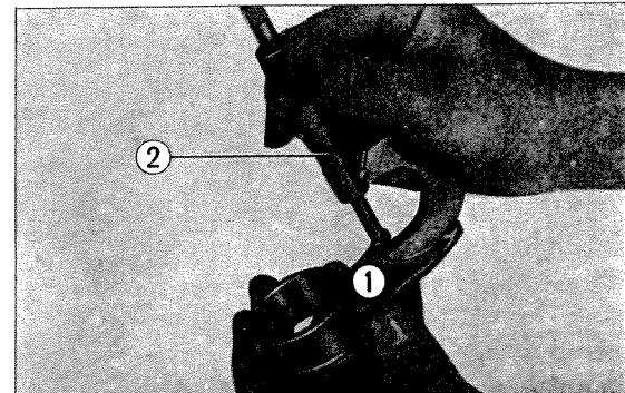
① Gear shift fork ② Micrometer
